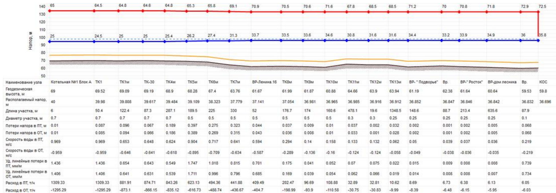
Рисунок 6 – Пьезометрический график от котельной Блок А до наиболее удалённого потребителя «КОС»
