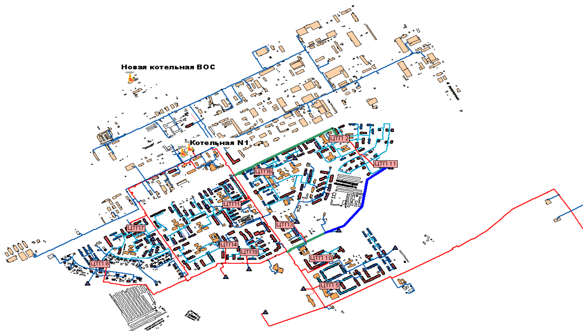
Рисунок 6.1 - Схема размещения централизованных теплоисточников и новой отопительной котельной в г.п. Федоровский
